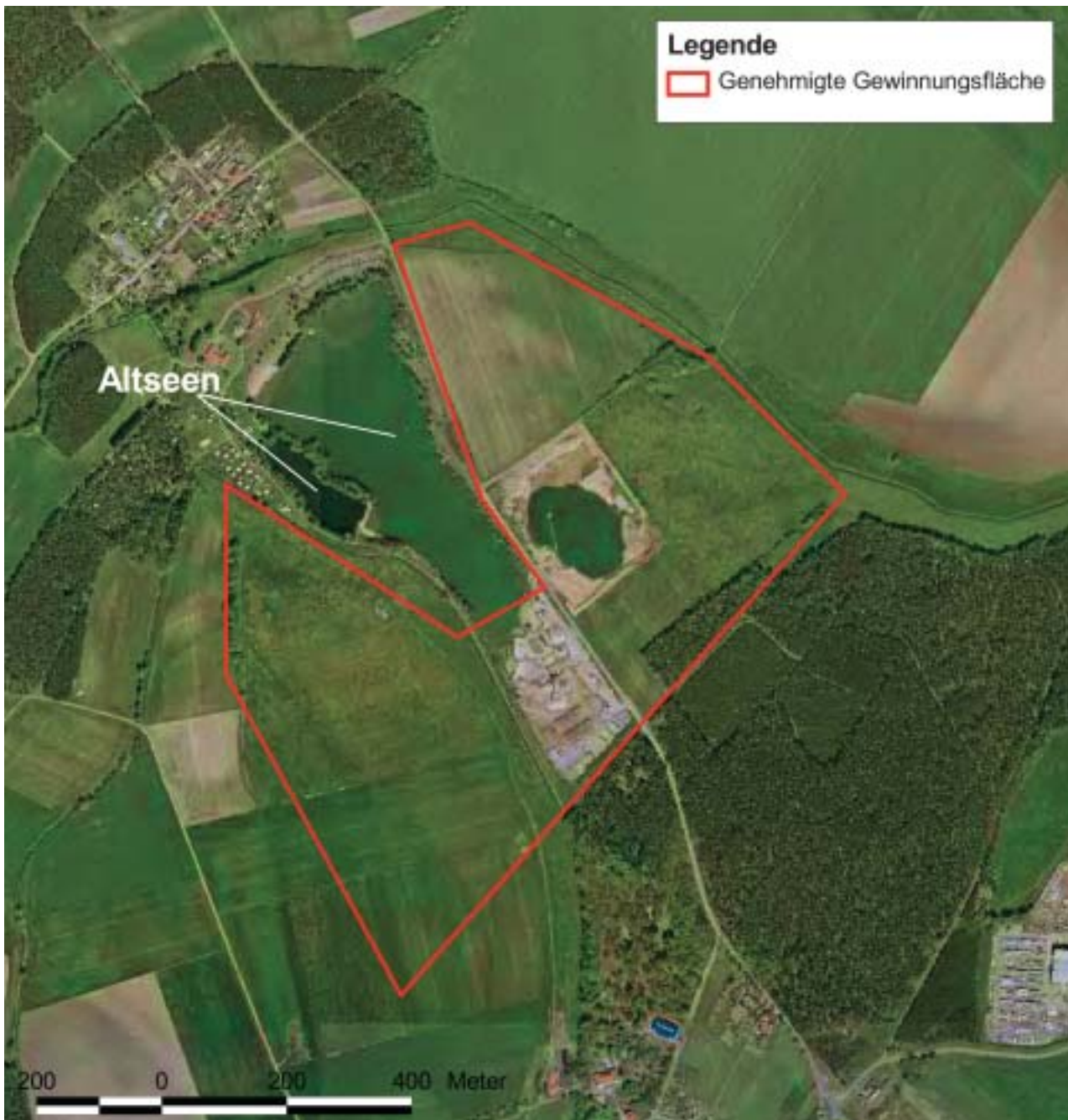
Abb. 1: Die Gewinnungsstelle (rot umrissen die Kontur des Bewilligungsfeldes Z.I). Der Abbau geht hier in einem Teilbereich eines ausgedehnten Sandergebietetes um, das während der Maximalausdehnung des sog. „Brandenburger Stadiums der Weichselvereisung“ gebildet wurde.
