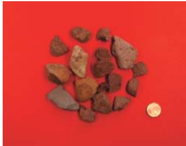
Abb. 22: Weicher Ton- und Schluffstein. Diese „saugende“ Komponente kann die Festigkeit des Betons nachteilig beeinflussen.
