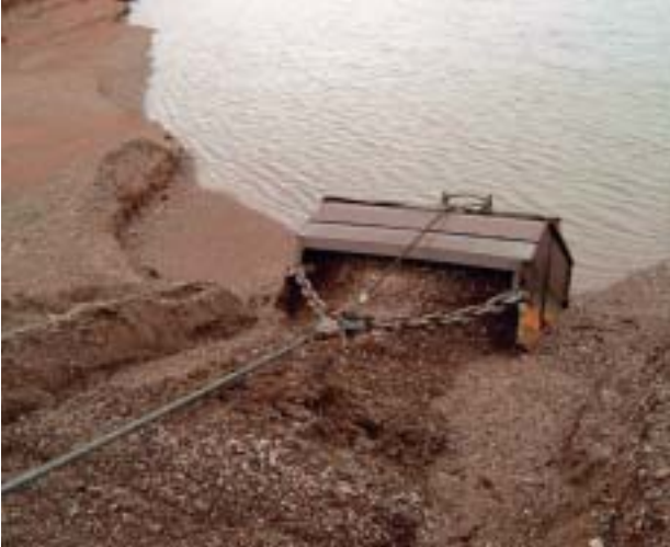
Abb. 8: Kiessandgewinnungsstelle IV-2 (saale- und weichselzeitliche Nieder- und Hauptterrassenschotter der Helme). Hier wird der Rohkies mit einer Zugschaufel (Schrapper) aus dem Wasser gewonnen. Das Probenmaterial konnte unmittelbar während der laufenden Förderung aus der Zugschaufel entnommen werden.
