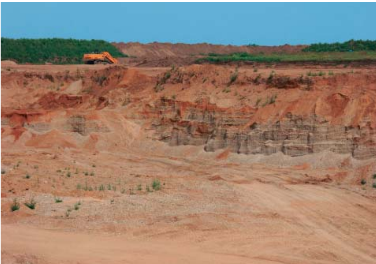
Abb. 30: Gewinnungsstelle II-4. Unter einer Abraumbedeckung von ca. einem Meter lagern hier saalezeitliche Hauptterrassenschotter in Mächtigkeiten von 5–9 m. Im Hintergrund Abraumverwaltung als Zwischenablage zur Rekultivierung.
