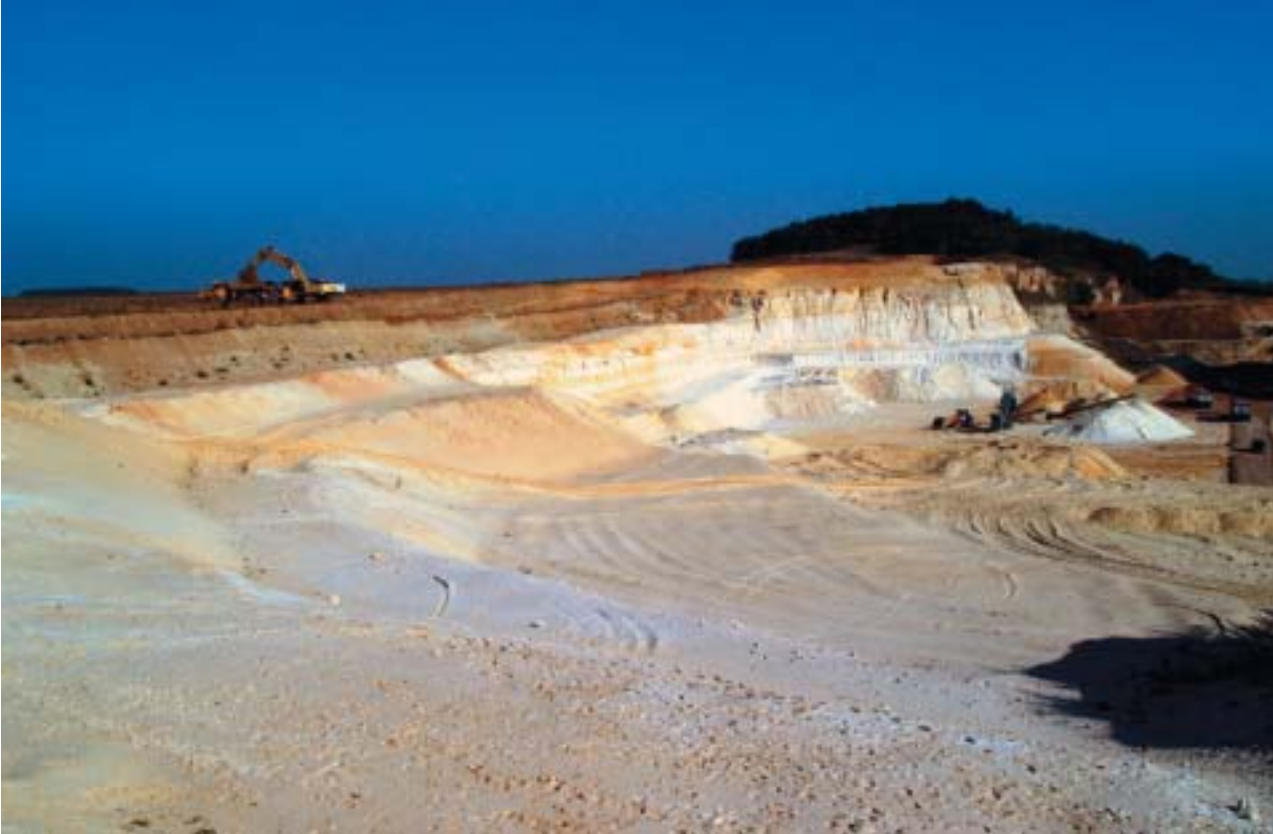
Abb. 15: Gewinnung von Quarzsand am Lehofberg bei Quedlinburg. Die hier anstehenden mürben Sandsteine der Oberkreide liefern ein wichtiges Industriemineral, das auch außerhalb Sachsen-Anhalts z. B. zur Herstellung von Wasserglas zum Einsatz kommt.
