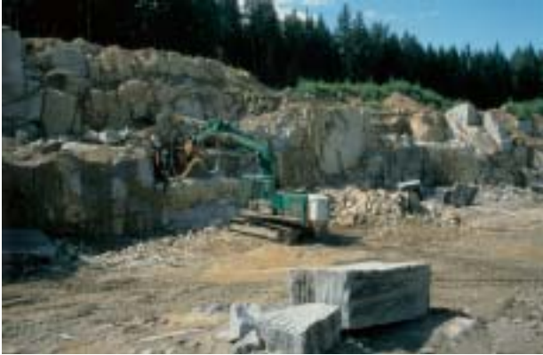
Abb. 2: Werksteingewinnung im Steinbruch Kleiner Birkenkopf bei Hasserode. Hier wird seit vielen Jahrzehnten mittelkörniger Brockengranit (Varietät „Brocken Blau“) abgebaut.
