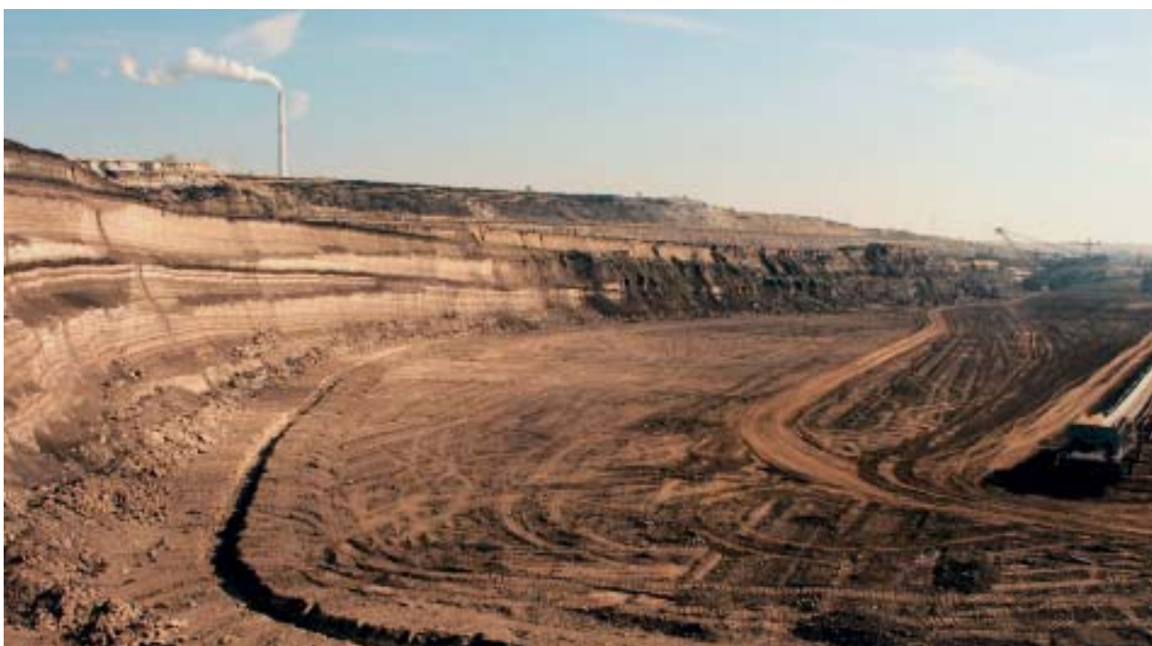
Abb. 1: Braunkohlegewinnung im Tagebau Amsdorf. Seit der zweiten Hälfte des 19. Jahrhunderts werden im Oberröb-linger Revier aus der Braunkohle wertvolle wachshaltige Inhaltsstoffe für zahlreiche industrielle Anwendungen extrahiert. Auch dieser umfassende Eingriff in Natur und Landschaft wird nach Beendigung der Gewinnungsarbeiten durch Umsetzung landschaftspflegerischer Begleitpläne und Nachfolmaßnahmen (Wiedernutzbarmachung) langfristig kompensiert werden.
