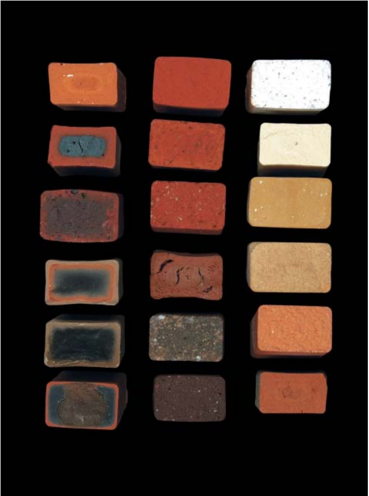
Abb. 6: Spektrum von gebrannten Prüfkörpern (Blick auf die Bruchfläche, Breite ca. 20–25 mm). Aus den Rohstoffen wurden für DIN-gerechte Untersuchungen durch Vakuumstrangformgebung Prüfkörper hergestellt und gebrannt. An diesen Produkten konnten die üblichen Kennwerte, wie z. B. Trocken-, Brenn- und Gesamtschwindung, Trockenbruchfestigkeit, Brennfarbe, Druckfestigkeit oder Kernausbildung ermittelt werden.
