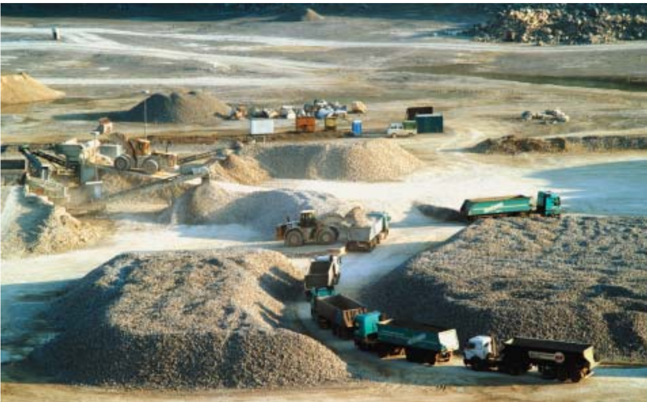
Abb. 13: Verladung von „Zuckersteinen“ im Tagebau Elbingerode. Ein nicht unerheblicher Teil der Kalksteinförderung kommt auch außerhalb der Bauindustrie zum Einsatz. Unentbehrlich ist hochreiner Kalkstein u. a. auch für die Zuckerherstellung. Hierfür sind saisonal kurzfristig große Mengen bereit zu stellen.
