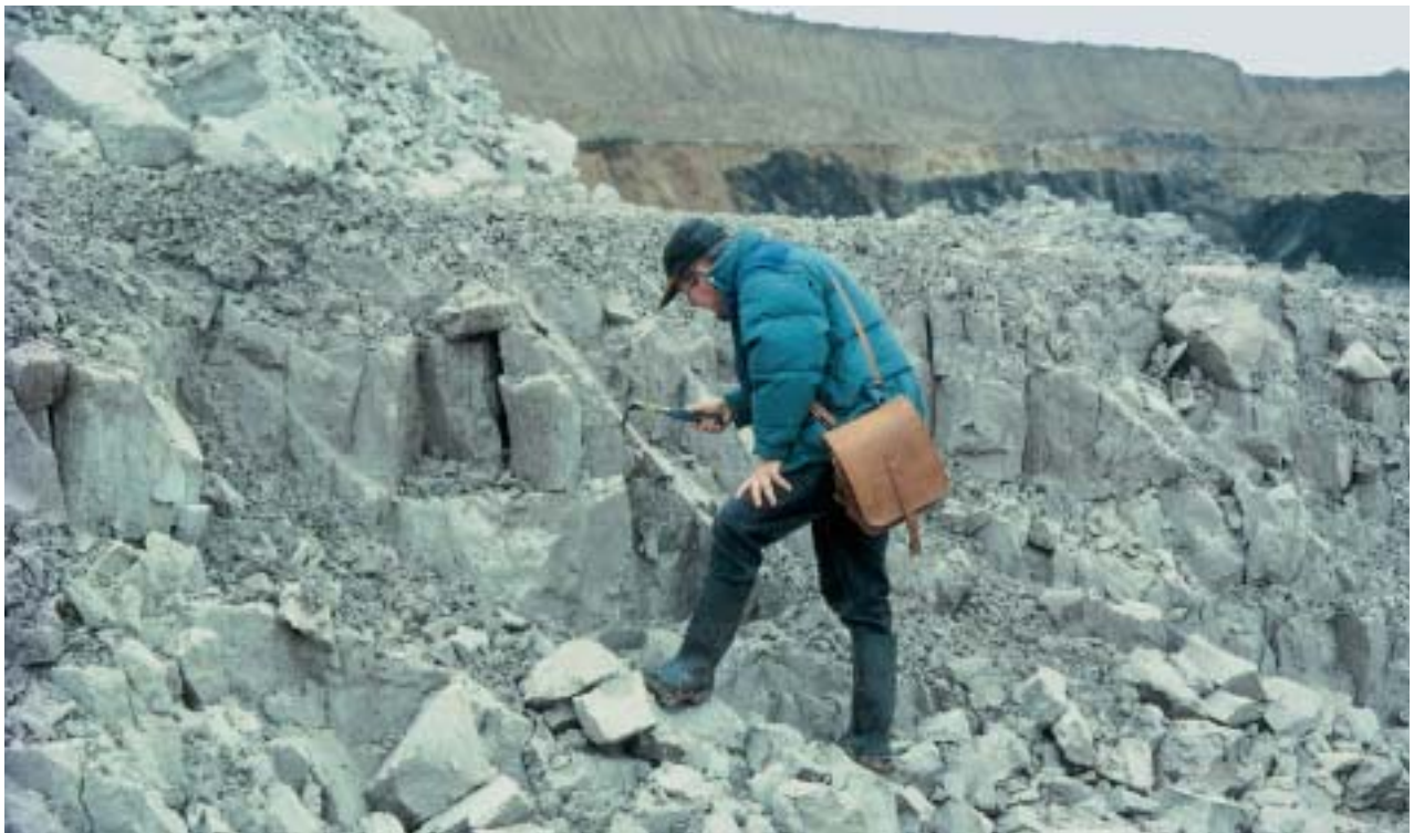
Abb. 12: Der Eozänton von Grana. Diese hochwertigen Tone sind an die Verbreitung der Braunkohlenflöze in den einzelnen Tertiärbecken gebunden. Im Hintergrund des Bildes stehen im Hangenden des Tons noch die Reste eines im Tiefbau verharnten Kohlenflözes an.
