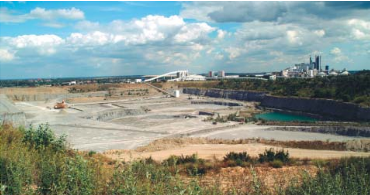
Abb. 4: Kalkstein-Tagebau und Zementwerk bei Bernburg. Auf der Basis des oberflächennah anstehenden Muschelkalks entwickelte sich schon vor Jahrzehnten im Raum Bernburg-Staßfurt eine bedeutende Grundstoffindustrie. Massive Neuinvestitionen legten hier in den letzten Jahren die Grundlagen zum Erhalt einer wettbewerbsfähigen Zement- und Sodaproduktion. Oberhalb des Tagebaus befindet sich das Mischbett mit Bandförderung zur Zementfabrik (rechts).
