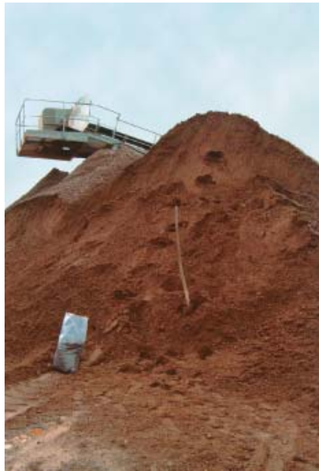
Abb. 11: Kiessandgewinnungsstelle IV-4 (saale- und weichselzeitliche Nieder- und Hauptterrassenschotter der Helme bei Sangerhausen). Hier erfolgte die Probenahme durch Homogenisierung von Punktproben (Sammelprobe ca. 30 kg), die der Rohkieshalde entnommen wurden.
