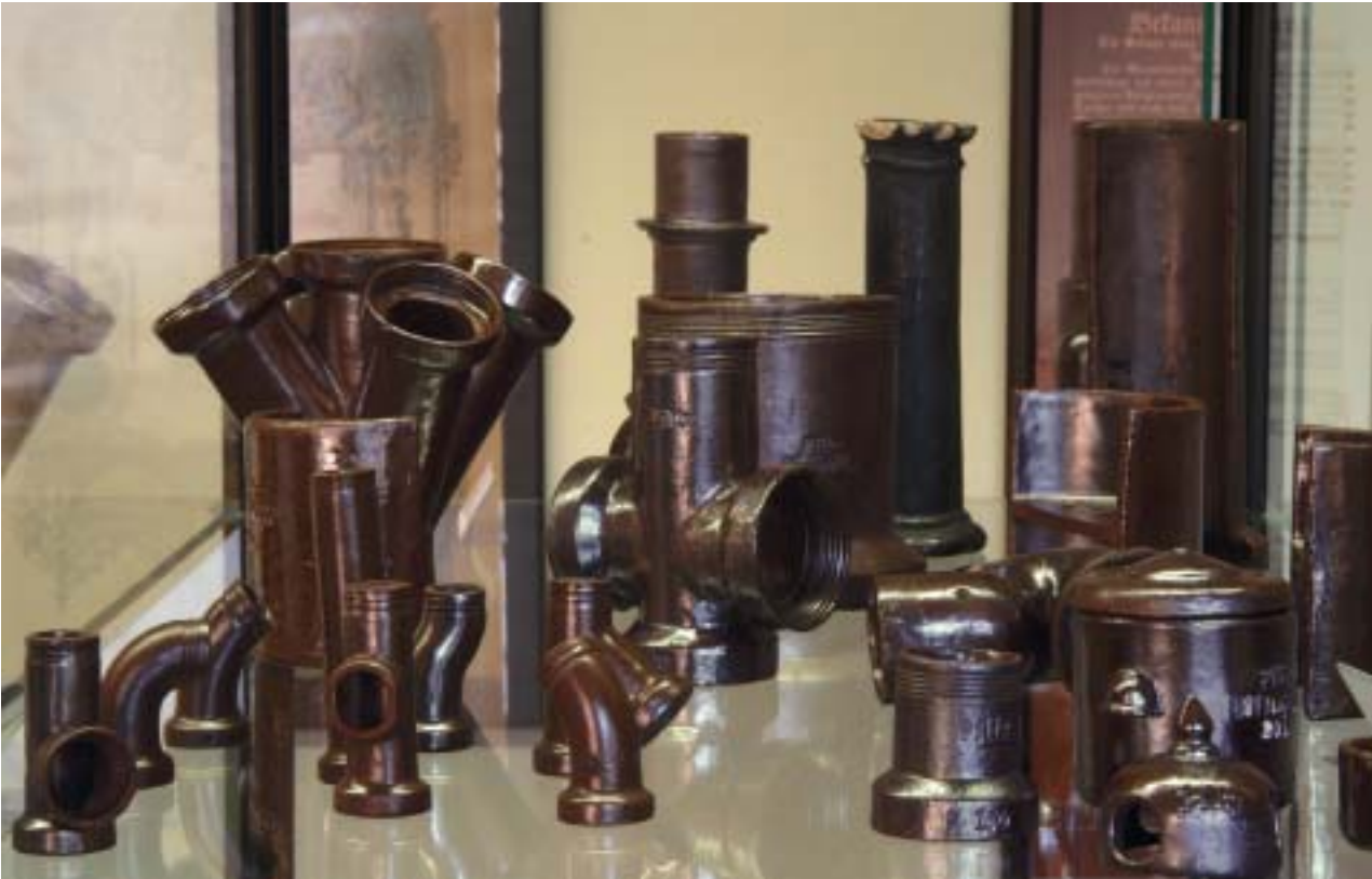
Abb. 9: Steinzeugrohre aus Bitterfelder Deckton (aus der Musterkollektion der ehem. Fa. BAUERMEISTER & Co., Kreismuseum Bitterfeld).
