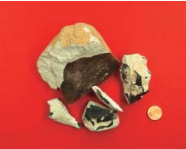
Abb. 21: Kreidekrusten-Flint. Diese problematische Komponente wird in ursächlichem Zusammenhang mit Alkali-Kieselsäure-Reaktionen und Betonschäden gebracht.
