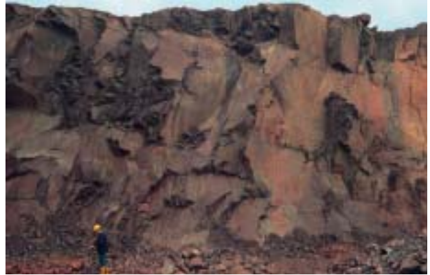
Abb. 3: Gewinnung permokarboner Andesite in der Flechtingen Scholle (Mammendorf). Dieser jüngste Hartgesteinsabbau Sachsen-Anhalts liefert hochqualitative Produkte für unterschiedliche Anwendungen (z. B. Straßen- und Wasserbau).
