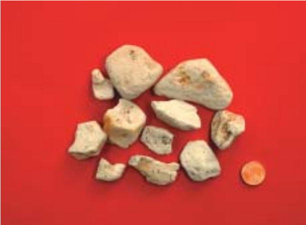
Abb. 19: Weiche z.T. poröse Kreidegerölle aus dem Subherzyn. Diese ungeeignete Komponente kann zu Treibreaktionen im Beton führen.
