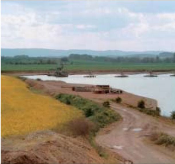
Abb. 31: Gewinnungsstelle III-1 – Blick von der Rohkieshalde zum Gewinnungsbereich der Abbaustelle, im Hintergrund als wichtigstes Liefergebiet der Harz. Auf der Wasserfläche sieht man das Gewinnungsgerät und die schwimmenden Bandübergabestationen zur landgestützten Bandanlage.
