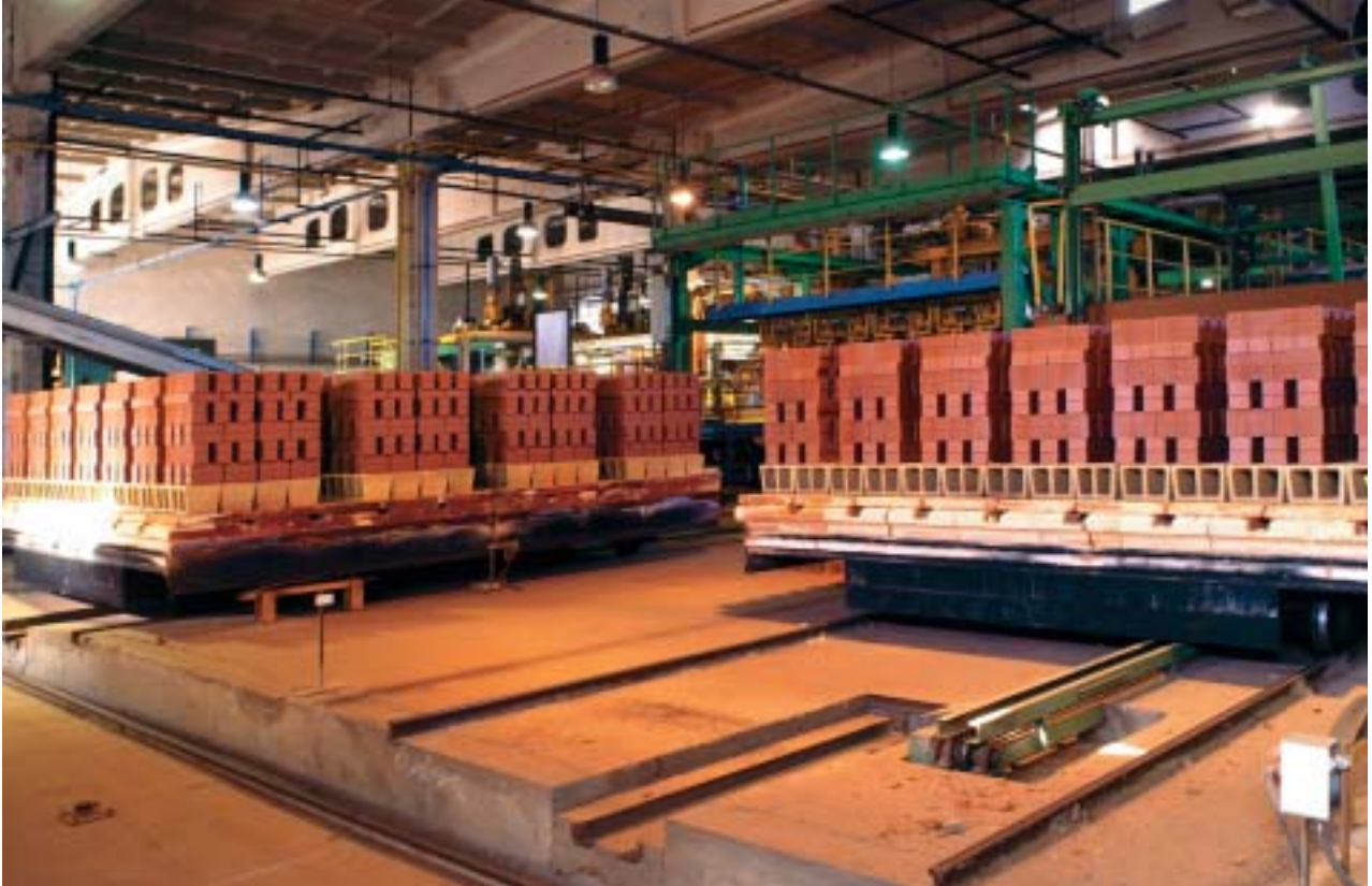
Abb. 22: Vormauerziegel verlassen die Tunnelöfen (Baalberge bei Bernburg).
