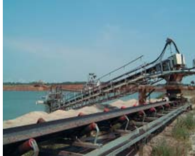
Abb. 9: Kiessandgewinnungsstelle I-6 (Elbe-Niederterrasse, nördlich Burg). In dieser Gewinnungsstelle erfolgt der Nassabbau mit Schwimmgreifer. Nach Anhalten des Förderbandes konnte hier eine Mischprobe des aktuell in Abbau stehenden Rohstoffes gezogen werden.
