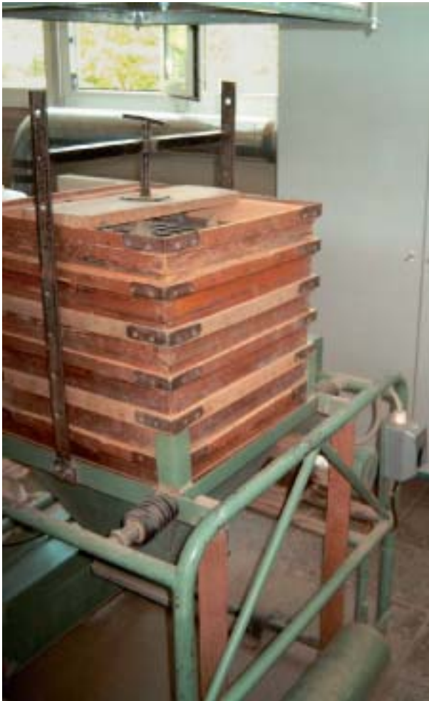
Abb. 12: Halbtechnische Siebanlage mit verschiedenen Aufsätzen (Maschenweite: 31,5, 16, 8; 4 u. 2 mm). Mit dieser Anlage wurde die gesamte Probenmenge entsprechend der o.g. Siebe in die Einzelfractionen getrennt.
