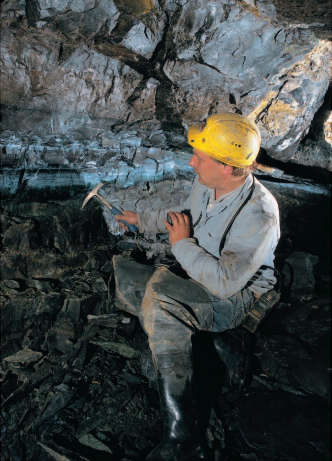
Abb. 26: Aufschluss des Kupferschieferflözes im Freieslebenschächter Flözgraben. Hier steht eine zinkreiche Vererzung an. Der Hammer markiert den Grenzbereich Weißliegendes / Feine und Grobe Lette.
