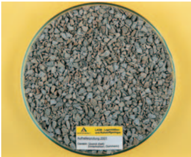
Abb. 2: Gommernquarzit –Varietät hell, hellbräunlichgrau, feinkörnig mit mm starken hellrötlichen Lagen und Schlieren, sehr fest, überwiegend gedrungen brechend.
