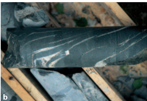
Abb. 3: Geologische Erkundung im Verbreitungsgebiet der Selke Grauwacke (2002). a. Bohranlage, b. Bohrkern mit feinkörniger heller Grauwacke und intensiver Quarz-Calcit-Durchtrümerung.
