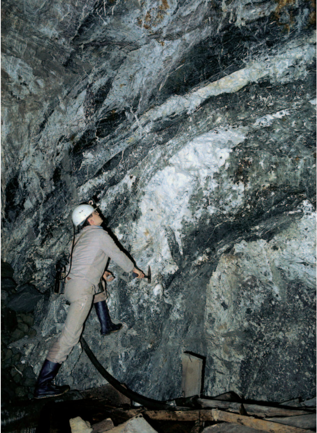
Abb. 20: Ostlinse Grube Fluor bei Straßberg. Das Foto zeigt das östliche Ende der bauwürdigen Spatführung im Biwender Gangzug. Der Liegende Teil des mächtigen Gangmittels besteht aus einer mehrphasig gebildeten Fluorit-Calcit-Quarz-Mineralisation mit dunklen Nebengesteinsbruchstücken (9. Sohle, April 1990).
