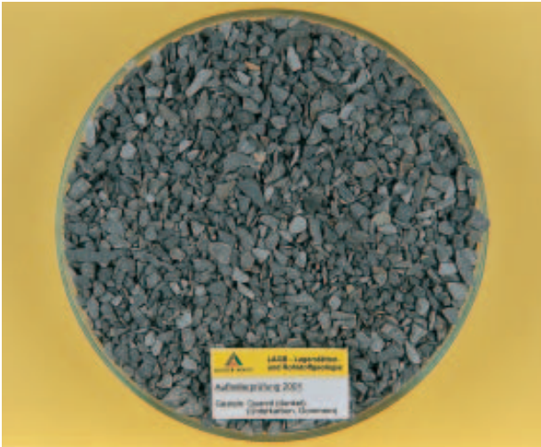
Abb. 4: Gommernquarzit, Varietät dunkel, mittelgrau, dicht bis feinkörnig, mit hellgrauen mm starken dunklen Schlieren und Lagen, sehr fest, in der Prüfkörnung scharf länglich splittig brechend.
