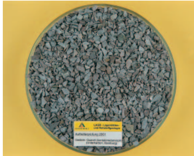
Abb. 3: Quarzit (Ilseburg), hellviolettgrau, überwiegend feinkörnig bis dicht, sehr fest, gedrungen bis schwach splittrig brechend.
