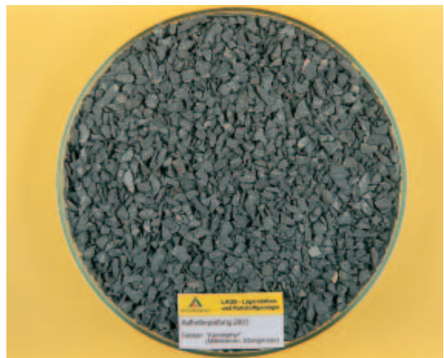
Abb.12: Keratophyr/Mikrosyenit (Elbingerode), dunkelgrau, dicht bis feinkristallin, vereinzelt Quarz auf Klüftbelägen, sehr fest, in der Prüfkörnung flachstänglich - splittrig brechend.
