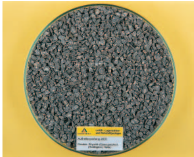
Abb. 9: Rhyolith, (Oberer Hallescher Porphyry, Brachstedt), violettbraun, zahlreiche kleine, helle Feldspateinsprenglinge in dichter bis feinkristalliner Grundmasse, fest, in der Prüfkörnung gedrungener Bruch.
