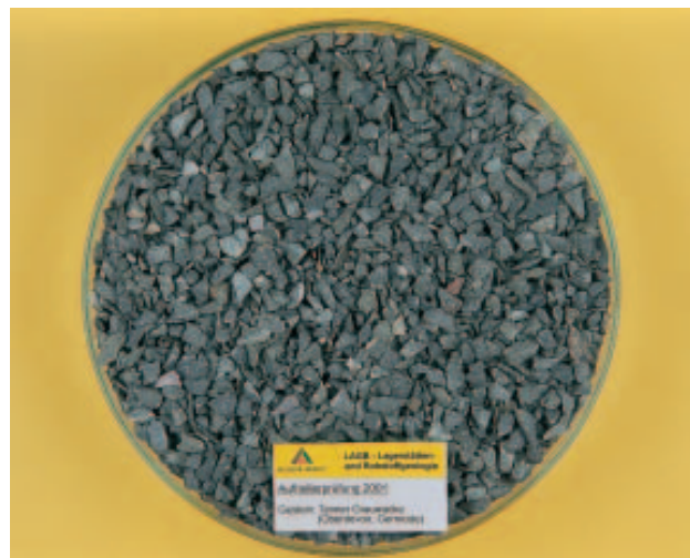
Abb.6: Grauwacke (Gernrode), dunkelgrau, feinkörnig, selten grobkörnig, vereinzelt Quarz auf Klüften, sehr fest, in der Prüfkörnung überwiegend scherbis-splittig brechend.
