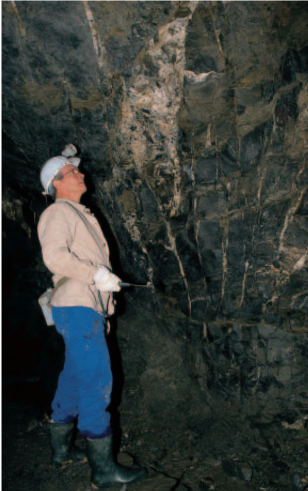
Abb. 40: Aufschluss einer Rückenmineralisation im Freiesleben-Schächter-Flözgraben unterhalb des Zabenstedter Stollens. Die Vererzung besteht hier vorwiegend aus Baryt mit Spuren von Kupfer-, Nickel- und Kobaltmineralen.
