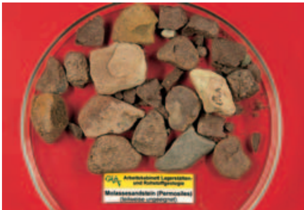
Abb. 6: Gering verfestigte Ton-, Schluff- und Sandsteine des Permokarbon (Raum Halle-Bernburg). Als ungeeignete Komponenten können sie zur Entfestigung des Betons beitragen.
