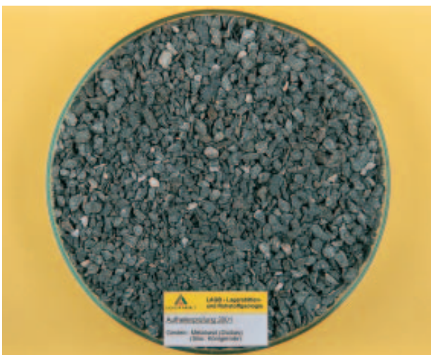
Abb. 11: Diabas/Metabasit (Königerode), dunkelgrau, schwach grünlich, feinkristallin, Quarze auf Klüftbelägen, fest, in der Prüfkörnung überwiegend gedrunen brechend.
