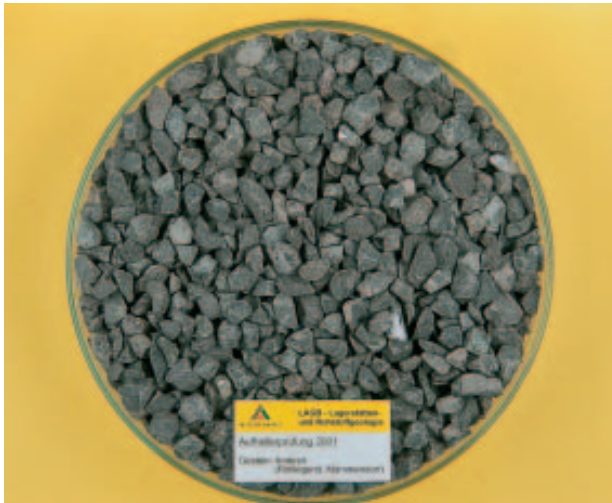
Abb. 10: Andesit (Mammendorf), dunkelviolettbraun, dicht bis feinkristallin, fest, in der Prüfkörnung gedrunen brechend.
