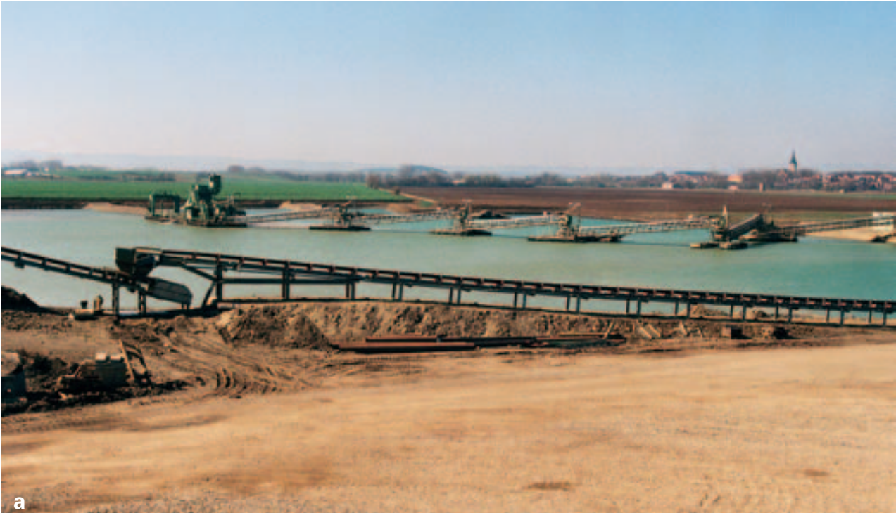
Abb. 2: In Gewinnung stehende Niederterrassenkiese im Subherzyn (Bodeaue) bei Ditfurt (Kreis Quedlinburg, im Hintergrund der Harz). (a) Die Nassauskiesung erfolgt hier großflächig mit Schwimmbagger. (b) Das hochqualitative Fördergut besteht hier vorwiegend aus Geröllen des Harz-Paläozoikums, untergeordnet sind mesozoische Sandsteine und Flint beteiligt.
