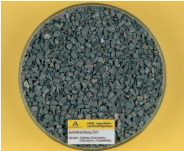
Abb. 7: Grauwacke (Südharz), dunkelgrau, überwiegend feinkörnig, Quarz auf Klüften, sehr fest, in der Prüfkörnung scharf-splittrig bis gedrungen brechend.
