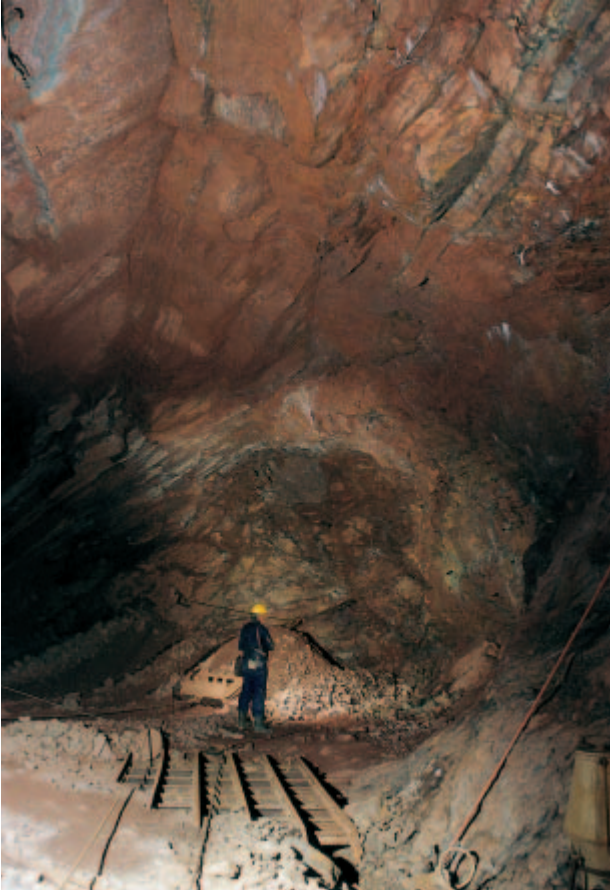
Abb. 16: Schaubergwerk Grube „Büchenberg“. Auf der 1. Sohle steht das steil einfallende Eisenerzlager mit einer Mächtigkeit von etwa sechs Metern an. Das Museum bietet neben der Lagerstättengeologie auch einen guten Einblick in die Abbautechnik (Schrapperabbau) der späten 60er Jahre des vergangenen Jahrhunderts.
