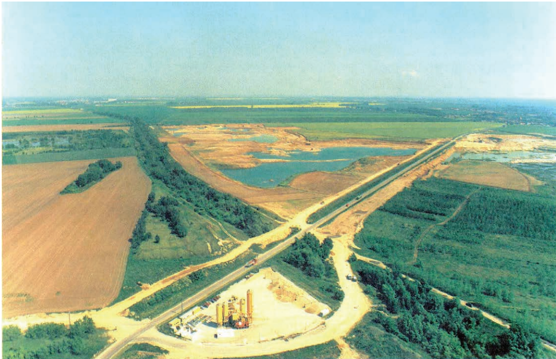
Abb. 7: Kiessandtagebau Wallendorf-Schladebach (Baufeld 4). Dieser Betrieb steht stellvertretend für zahlreiche Abbau in Sachsen-Anhalt, bei denen die Wiederurbarmachung unmittelbar der Naßgewinnung (in der Bildmitte) folgt (mit freundlicher Genehmigung Mitteldeutsche Baustoffe, Sennewitz; Foto: W. Ziegler, Halle).
