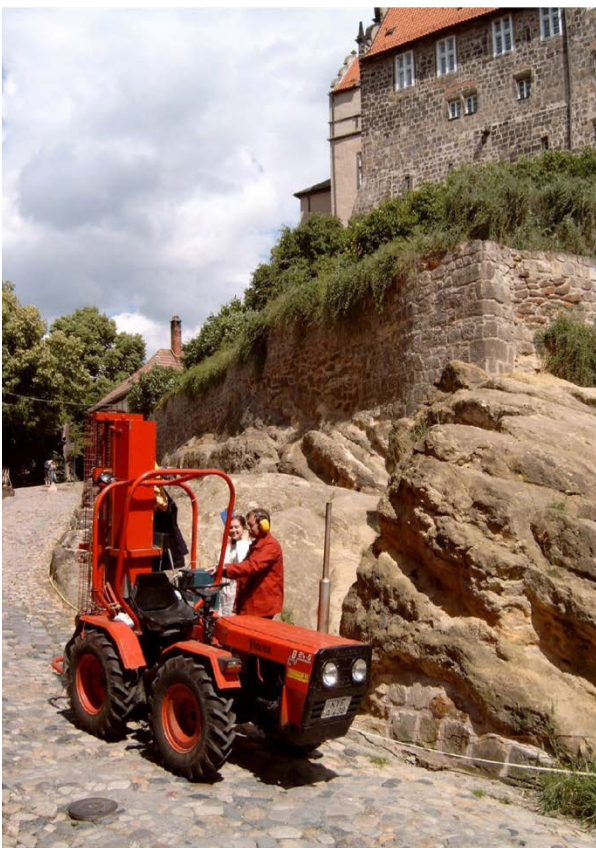
Abb. 2: Sandsteinfelsen am Fuße des Schlossberges mit seismischem Fallgewicht im Einsatz.
