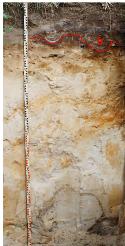
Abb. 4.7.: Reliktischer Gley mit ehemals humusreichem Oberboden. Die früher starke Vernässung wird durch Tropfenbildung (tr) an der Untergrenze des humosen Oberbodens und die dortige dunkelbraune Eisenanreicherung belegt. Im Seitenstoß des Schurfes befand sich ein verfüllter Entwässerungsgraben. Die aktuelle Absenkung des Grundwassers beträgt über 2 m.
