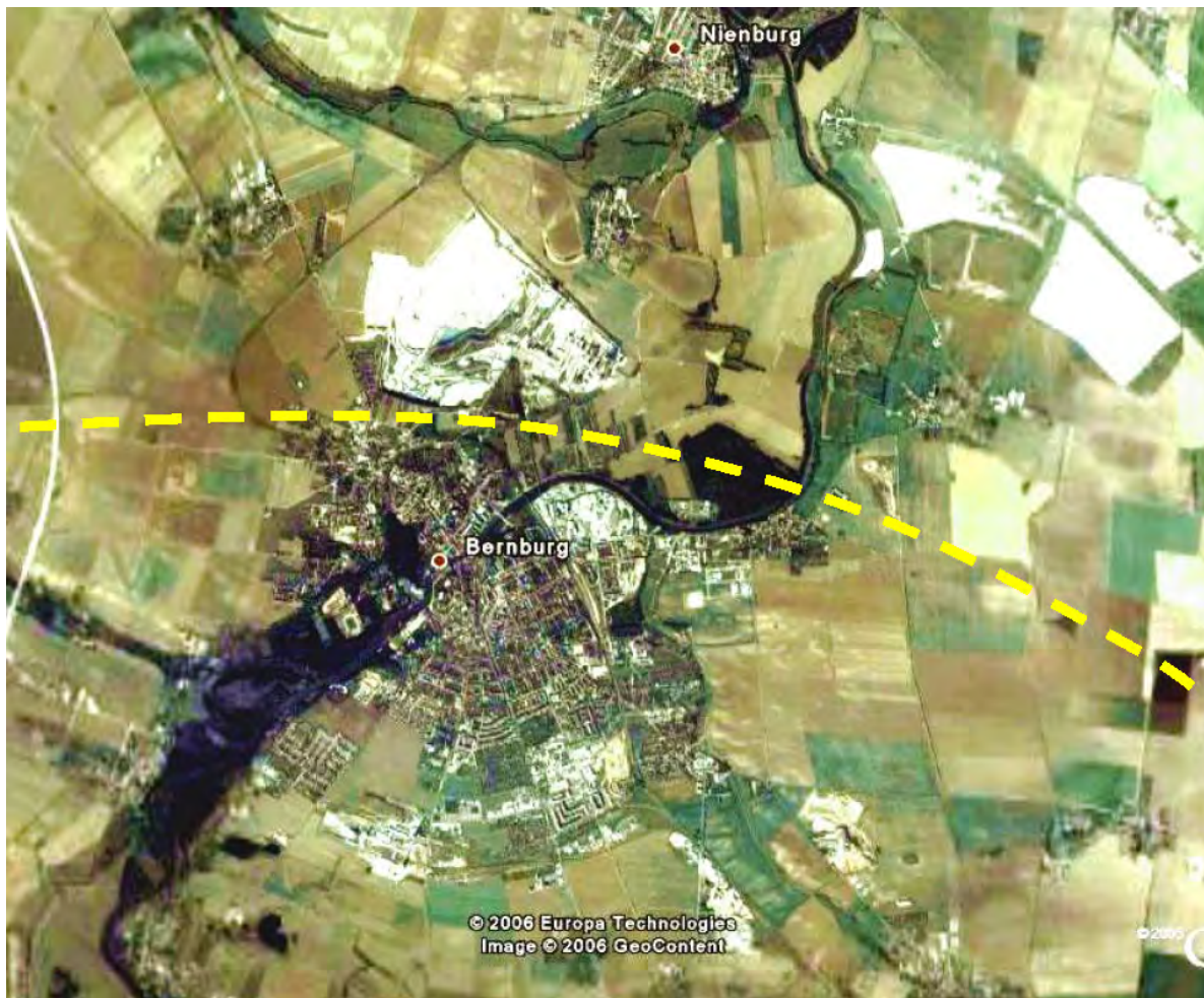
Abb. 1.1.: Flächennutzung und Nutzungskonflikte erfordern Bodeninformationen. Für den Raum in der Umgebung von Bernburg zeigt der Ausschnitt des Luftbildes eine dominierende Flächennutzung durch die Landwirtschaft. Neue Straßen (gelb gestrichelt) und geplante Gewerbegebiete (an der A14, links) sowie Erweiterungen von Tagebauen (helle Flächen nördlich von Bernburg) und Reststoffdeponien (im Nordosten) erfordern Flächenplanungen für Ausgleichs- und Ersatzmaßnahmen. Verlassene Standorte von Bergbau und Gewerbe sind zu rekultivieren (Wasserflächen im Südwesten).
