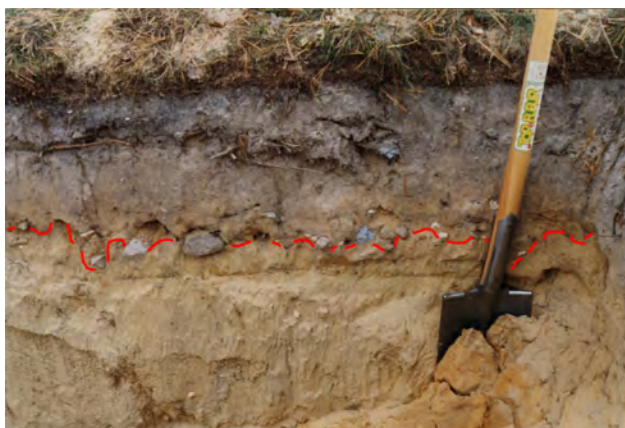
Abb. 4.2.: Steinsohlen sind häufig ein Zeichen für Schichtgrenzen. Ihre Ausbildung ist nicht immer so deutlich wie im Foto. Meist sind es Ausblasungspflaster oder Abspülungsreste. Sie kennzeichnen Erosionsphasen.
