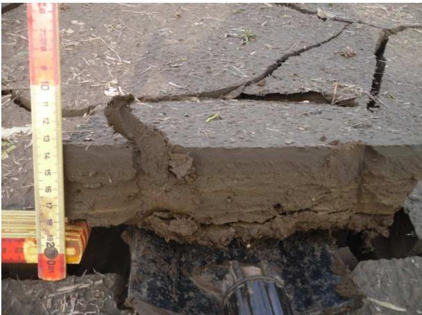
Foto 18: Sedimentiertes Bodenmaterial im Bereich der Übertrittsstelle Nr. 4.
