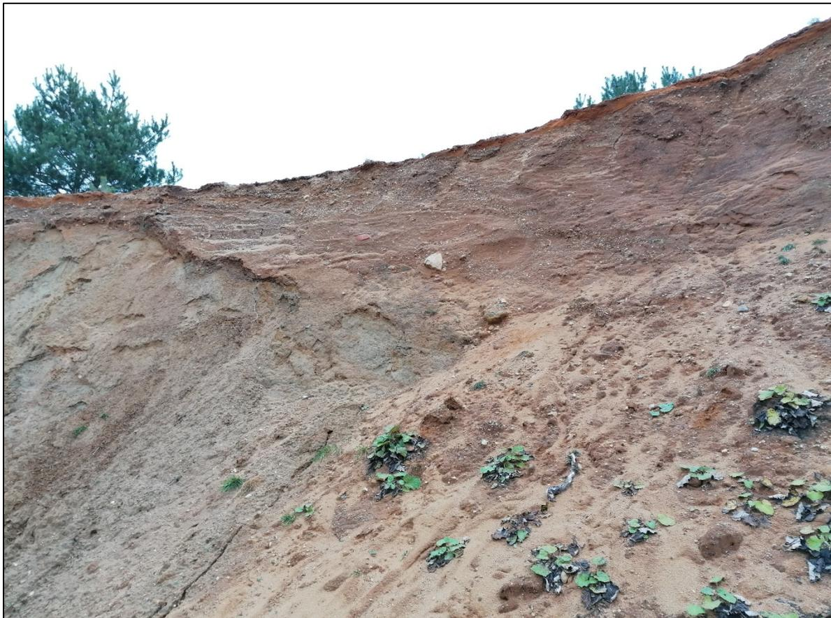
Blick nach Osten auf Ostböschung mit steilstehendem Geschiebemergel im oberen Böschungsbereich
