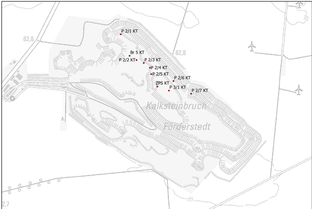
Abbildung 7 Grundwasserpegel bzw. Wasserstandsmessstellen im Bereich des Abbaus
