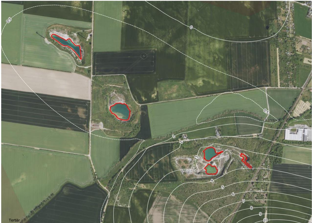
Abbildung 39 Absenkung bei maximaler Grundwasserbeeinflussung im Bereich des Marbegrabens ausgehend vom Istzustand
