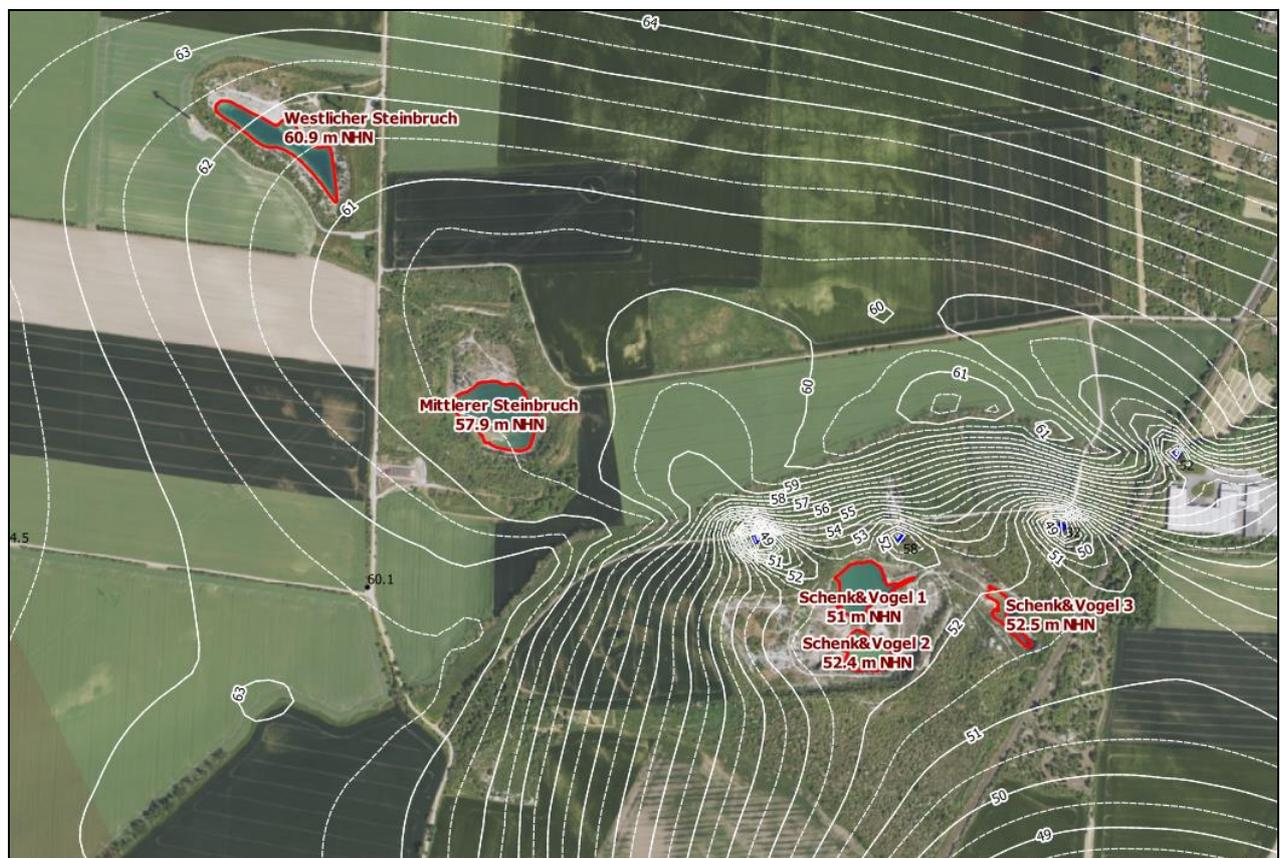
Abbildung 36 Freiwasserstände in den aufgelassenen Steinbrüchen nördlich des KT Förderstedt, ermittelt anhand des DGM 5 und aktueller Orthophotos nach [LAVG 23-2] (rot, in [m
