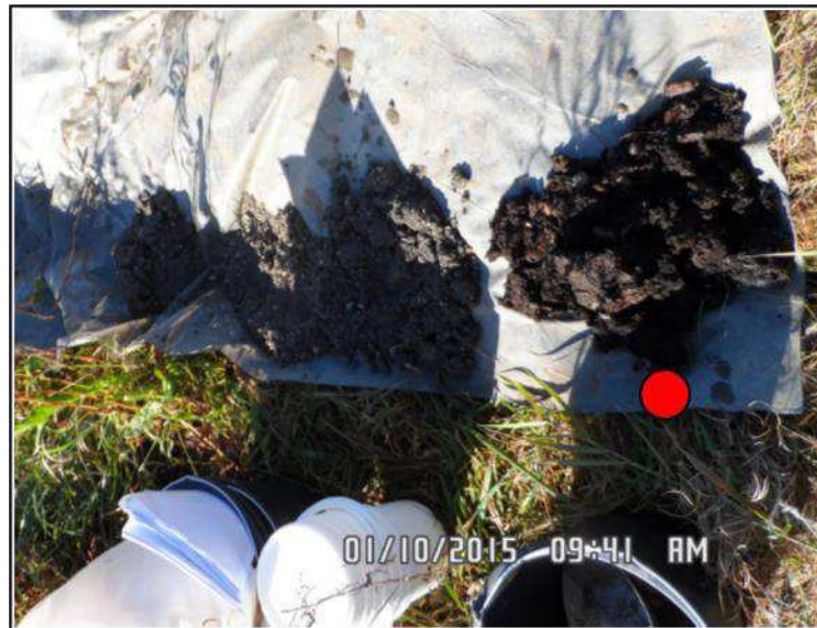
Abbildung 3-2: Bohrung B2/15 von rechts GOK nach links, deutlich erkennbar rechts im Bild die Torfbildung der Oberboden-schicht 0 bis 1,8 m u GOK.
