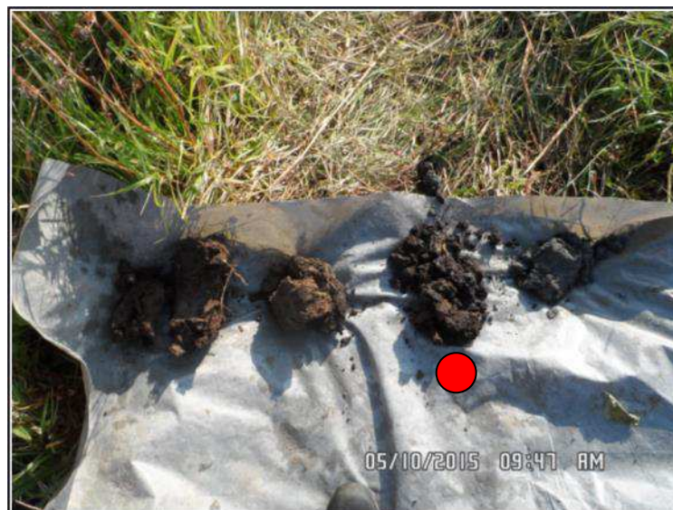
Abbildung 3-3: Bohrung B4/15 von links GOK nach rechts, die Torfbildung an dritter Stelle, 0,6 bis 1,4 m u GOK.
