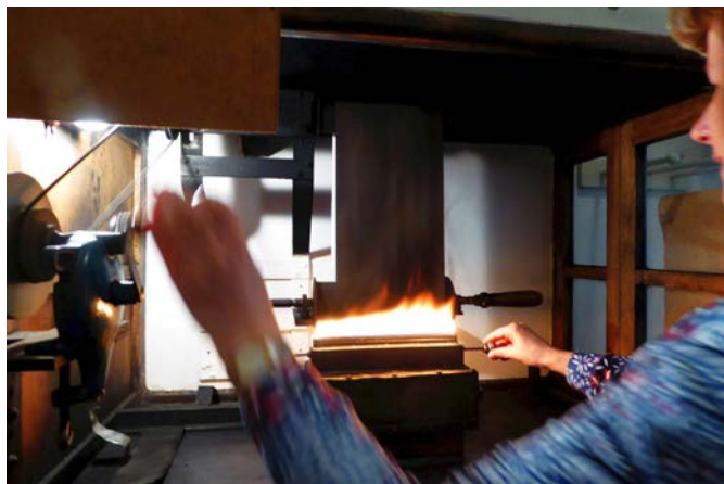
Abb. 5.1-12: Berußung der Streifen. Das Petroleum im Behälter sorgt für eine rußende Flamme. Der darübergehängte Streifen wird mittels Kurbel (links im Bild) gleichmäßig bewegt. Foto: L. Sachs.
